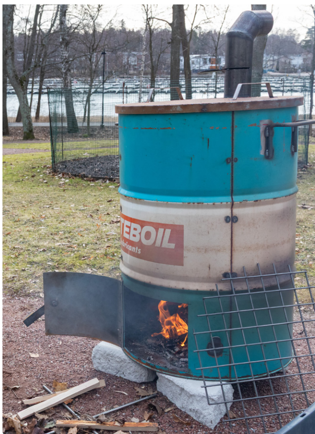
Mustasavustusta varten rakennettu savustustynnyri ulko- ja sisäpuolelta. Kuvat: Otto Santala ja Miia Kallio
