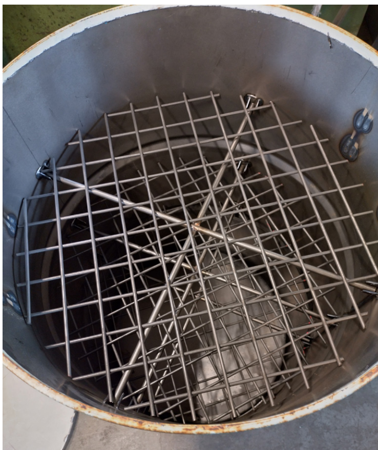
Mustasavustusta varten rakennettu savustustynnyri ulko- ja sisäpuolelta. Kuvat: Otto Santala ja Miia Kallio
